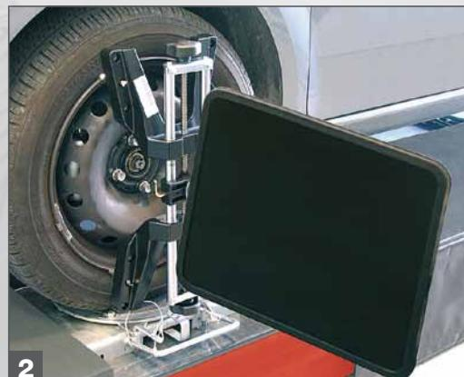
**TRIGON 4 Vision Platinum**, a nova **máquina de alinhar com alvos passivos com 8 telecâmeras digitais** de elevada resolução para a máxima precisão na medição. A automatização das operações de alinhamento e a extrema confiabilidade dos componentes exaltam sua produtividade.
