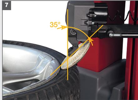
**8-9-10. Dispositivo de desmontagem SEM ALAVANCA**, aplicado ao sistema de extração, **elimina totalmente o esforço físico do operador e garante máxima segurança para o aro e o pneu.**
