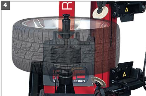
**4. Bloqueio do pneu integrado** que permite o posicionamento fácil da roda no dispositivo de centragem, sem nenhum esforço e permite destalonar os dois talões com um único movimento, sem ter que girar o aro.
