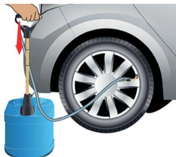
Cierre el grifo de la válvula y retire el conector de la válvula.
