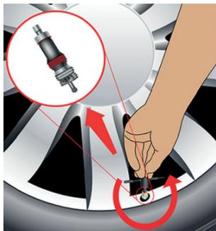
Conecte la bomba dosificadora a la válvula y abra el grifo de la válvula.
